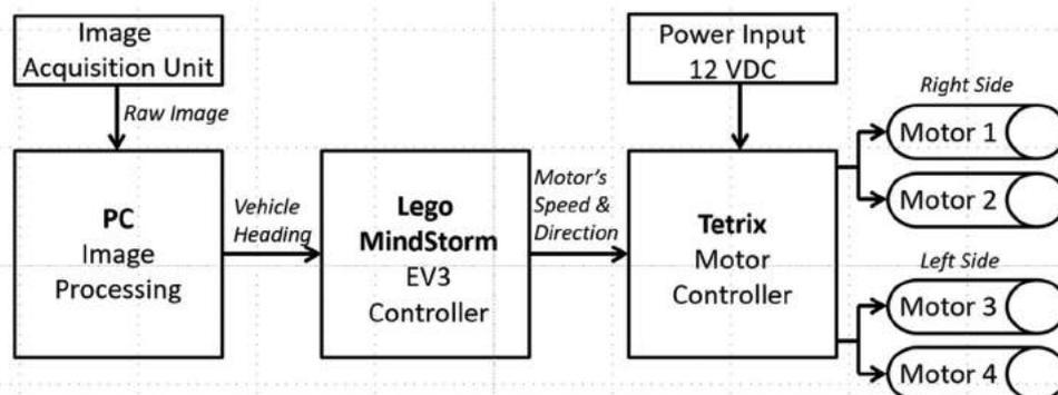
Fig. 3. Motor Control System.
